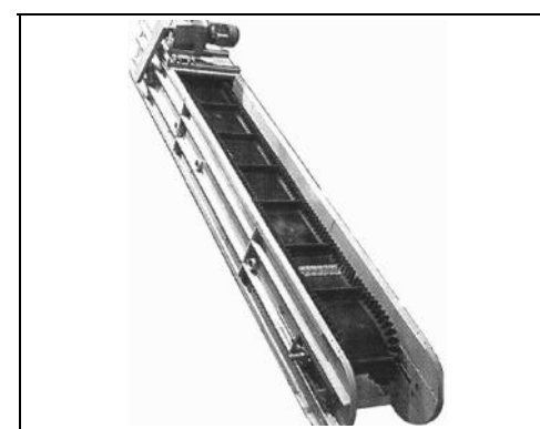
10. Guides latéraux languettes pour pente de 50°
