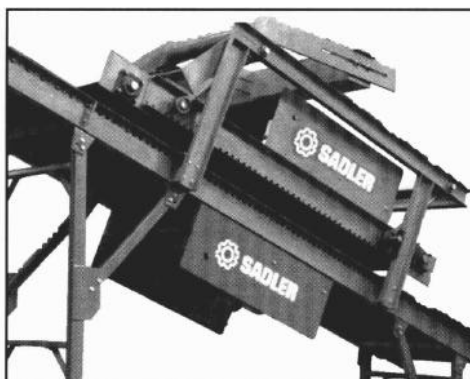
8. Convoyeur à courroie double pour aplatir les sacs
